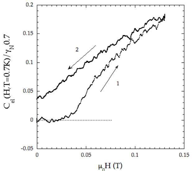
5. L'échantillon est refroidi en champ nul. Discutez qualitativement l'allure de la première montée en champ (partie 1). Quel champ critique cela permet-il de déterminer, à quelle(s) longueur(s) ce champ est-il relié ? Pourquoi  $C_{el}/T$  ne revient-elle pas à zéro lorsque  $H$  est lui ramené à zéro (partie 2).
